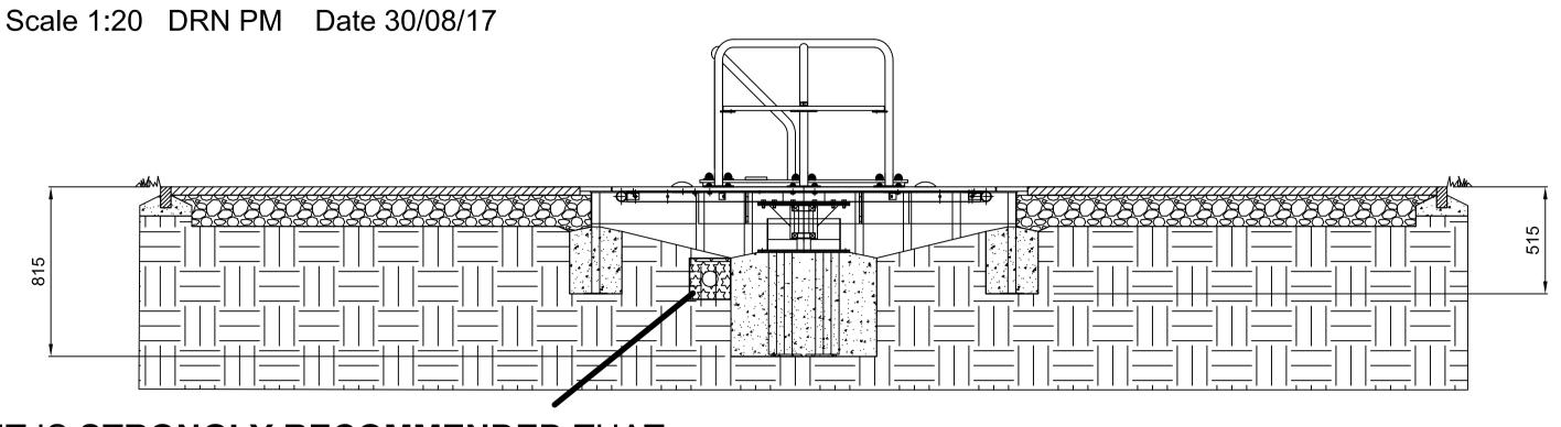
IT IS **STRONGLY RECOMMENDED** THAT APPROPRIATE DRAINAGE SHOULD BE CONSIDERED IN ORDER TO PREVENT WATER FILLING THE VOID UNDER THE ROUNDABOUT
