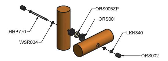
IMPORTANT NOTE TWIST THE RUBBER SPACERS SO THAT THEY ARE FLUSH AGAINST THE LOGS.
